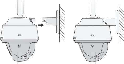
(3) 在下图位置两侧都打入自攻螺钉，将摄像机与支架固定。
