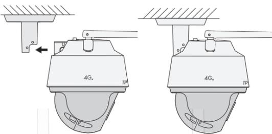
(3) 在下图位置两侧都打入自攻螺钉，将摄像机与支架固定。
